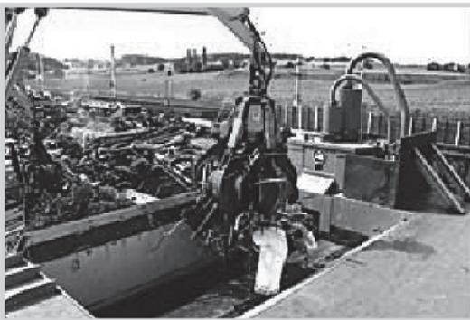
Das Alteisen wird im **Shredder zerkleinert** und gleichzeitig mittels **Magnet** von nichtmagnetischen Metallen getrennt. Diese **Separierung** des dabei anfallenden Eisenschrotts, der Buntmetalle und der Shredder-Leichtabfallart erfolgt mittels Luftabsaugung und Magnettrommel. Dem Shredder ist eine **Nicht-Eisen-Aufbereitungsanlage** nachgeschaltet. Der zerschnittene Schrott wird auf einem Rüttelwerk nachgereinigt, indem anhaftende Fremtteile
